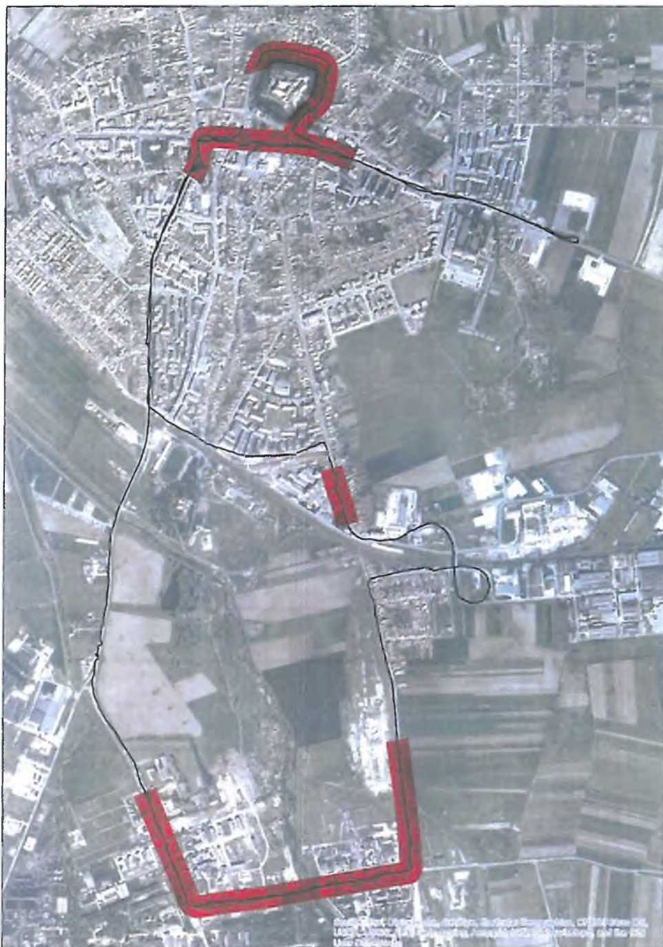
Figură 2-17 Zonele unde se înregistrează viteze scăzute de deplasare (<20 km/h)
